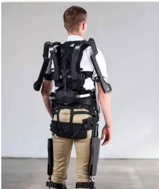
外骨骼机器人 作为一种高科技康复辅助设备，可与人体的动作协调，给人提供额外的动力或能力
